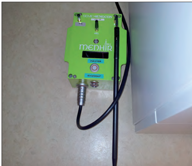
Abb. 12: Master mit Detailansicht der RF-Antenne
